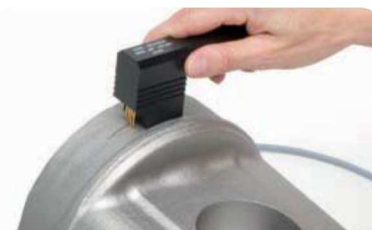
Pomiar pęknięcia kąтового
