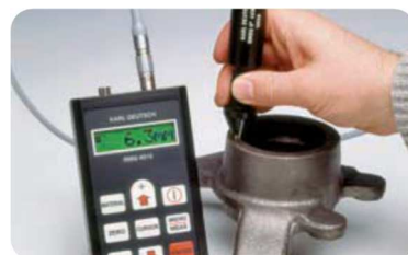
Pomiar pęknięcia na wąskiej powierzchni
